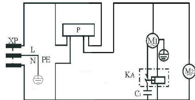
M1-压缩机 M2-冷却风机 KA-启动继电器 C1-启动电容
